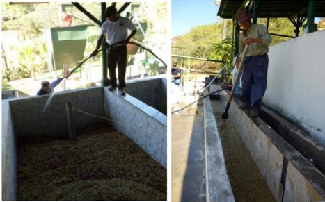
⑥醗酵槽に運ばれたパーチメントは、約16~17時間の醗酵工程がとられます。
