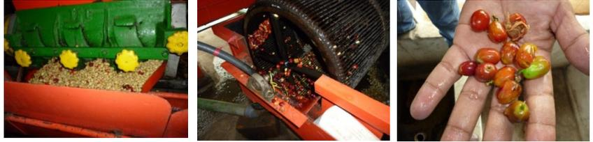
剥かれたパーチメントは、サイズが小さいので、クリバから飛び出し醗酵槽に運ばれます。剥かれなかったチェリーは、クリバの中に入ったままで、別処理に回されます。
