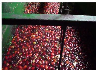
④水と一緒にゆっくり送られたチェリーは、まずは水による比重選別が行われます。比重が軽く浮いたチェリー(過熟、Empty、虫食いチェリー)は、Pulpingマシンには行かず別処理されます。同時に沈んだチェリー(完熟チェリー、未成熟チェリー)は、Pulpingマシンに進みます。この時、水はチェリーと分けられ、水はPulpingには使われず取って置き、次の工程で使われます。
